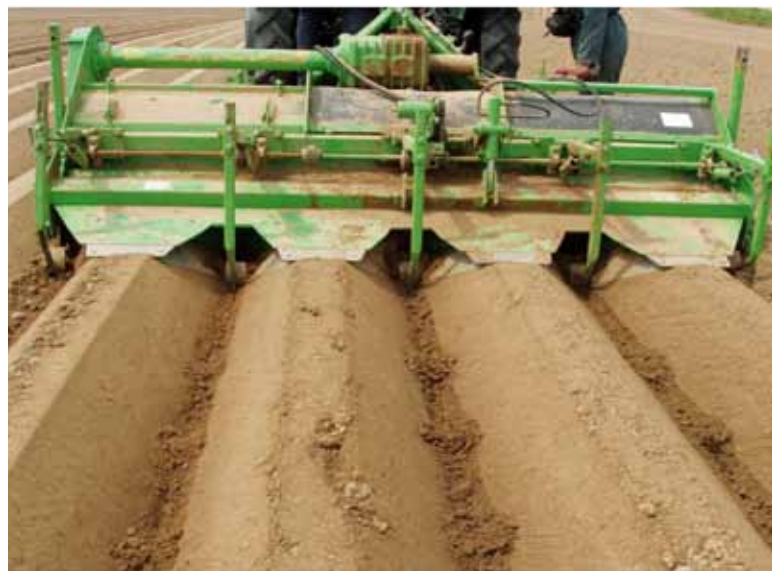
Bakhátak közti kis sáncok (képen a bakhátak közt)
