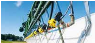
19. ábra: Növényterelővel felszerelt szórókeret
