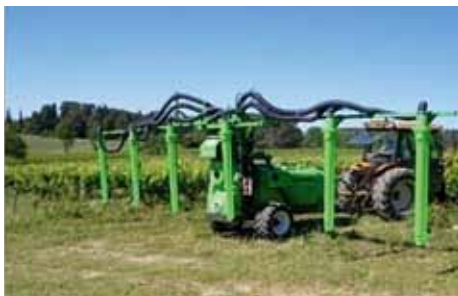
24. ábra: Többsoros permetezőgép a) fúvókákkal b) flexibilis légvezető csövekkel
