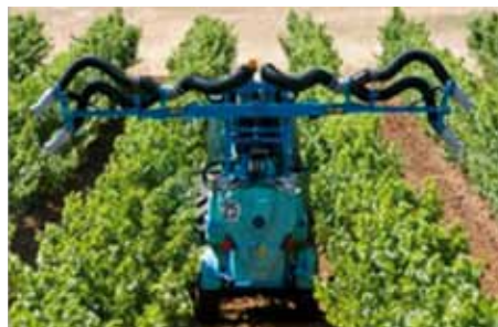
24. ábra: Többsoros permetezőgép a) fúvókákkal b) flexibilis légvezető csövekkel
